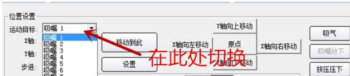
A. 选中任意一个位置（例如烧录位 1），在座子中放置一颗芯片，选择移动到此。（确保 1 号吸嘴的坐标位置已经调好），此时在“位置调节区”将运动目标切换为吸嘴 2，选择适当的步进距离，将吸嘴 2 移动到烧录位 1 的上方（注意：不要点移动到此），将位置调准确，使吸嘴放下后处于座子中芯片的中心，调准确后，点击设置。
